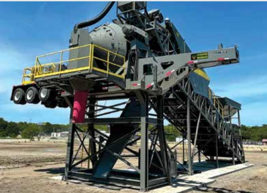
PLANTA DOSIFICADORA SHT CON MEZCLADORA INCLINABLE TM-14 Y SILOS ROBUSTOS DE ALMACENAMIENTO
