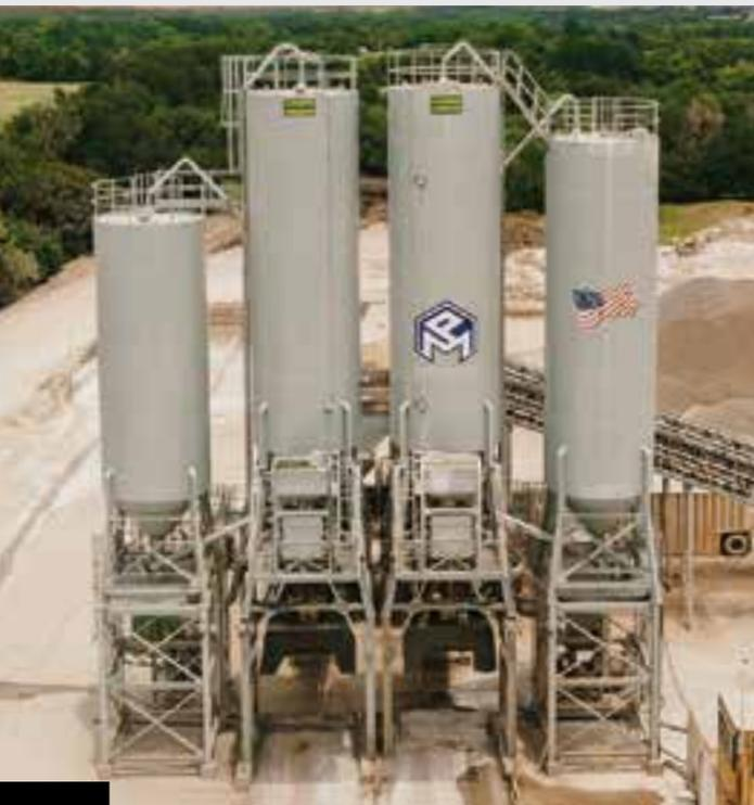
LPM DE DOBLE VÍA (SECA Y HÚMEDA) COMBINADA CON MEZCLADORA INCLINABLE ESTACIONARIA DE 14 YARDAS CÚBICAS
