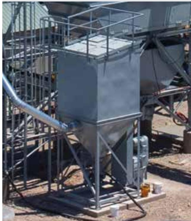
COLECTOR DE POLVO MONTADO SOBRE SILO
