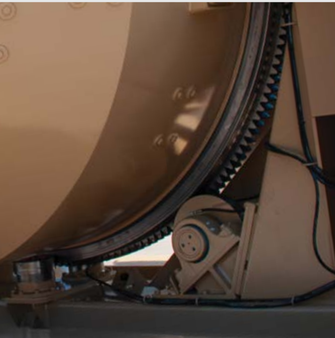
RODILLOS DE TAMBOR DE ALTA RESISTENCIA Y ENGRANAJE DE ANILLO REFORZADO
