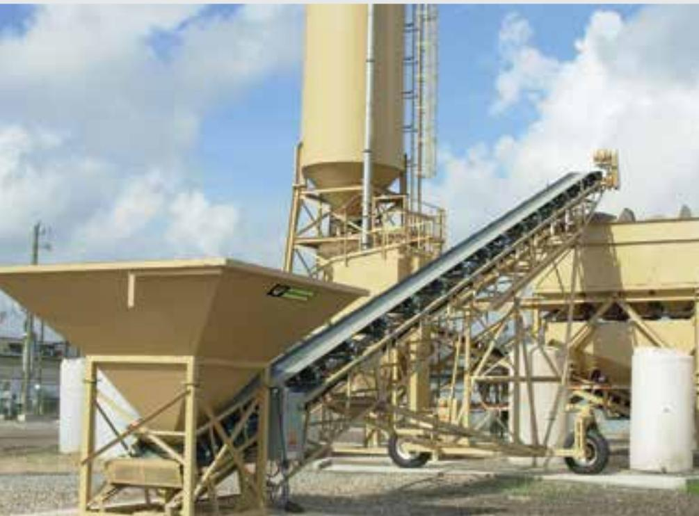
TRANSPORTADOR ESTACIONARIO CON CABEZAL GIRATORIO
