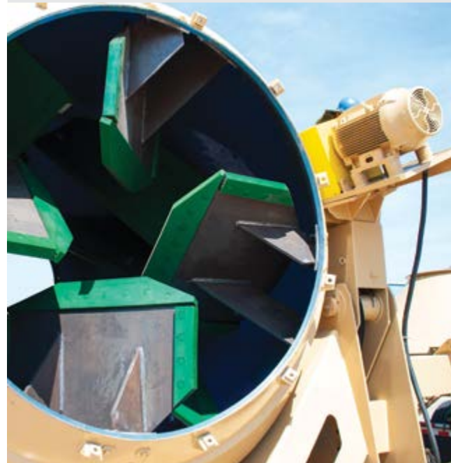
CUCHILLAS DE ACERO AR-400 CON REVESTIMIENTO DE POLIETILENO Y MOTORES GEMELOS DE 75 HP (CABALLOS DE FUERZA)
