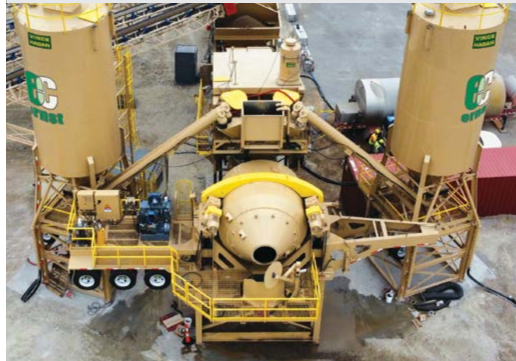
PLANTA DOSIFICADORA SHT CON MEZCLADORA INCLINABLE TM-12 Y SILOS ROBUSTOS DE ALMACENAMIENTO
