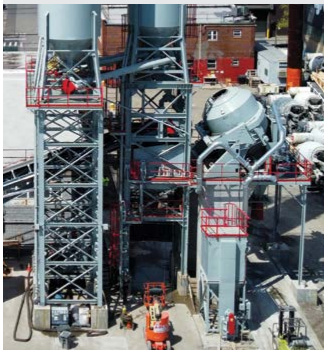
LPM DE DOBLE VÍA (SECA Y HÚMEDA) COMBINADA CON MEZCLADORA INCLINABLE ESTACIONARIA DE 12 YARDAS CÚBICAS
