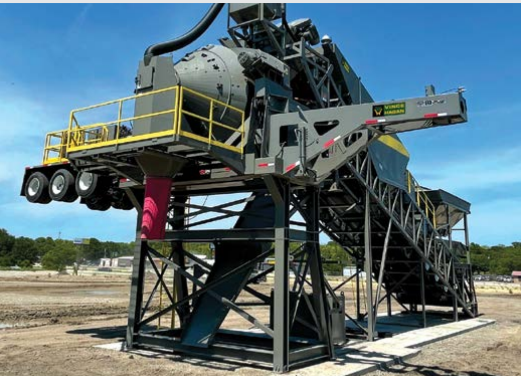
PLANTA DOSIFICADORA SHT CON MEZCLADORA INCLINABLE TM-12
